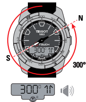
c) Die 6-/12-Uhr-Achse stimmt mit der Azimutrichtung überein
