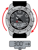
b) Drehen Sie die 6-/12-Uhr-Achse nach rechts, bis 12 Uhr in die Azimutrichtung zeigt
